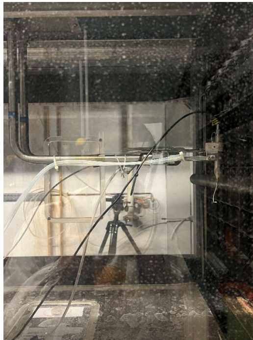
Figure 1.1 : Dispositif expérimental de l'étude du sillage turbulent d'un cylindre circulaire
