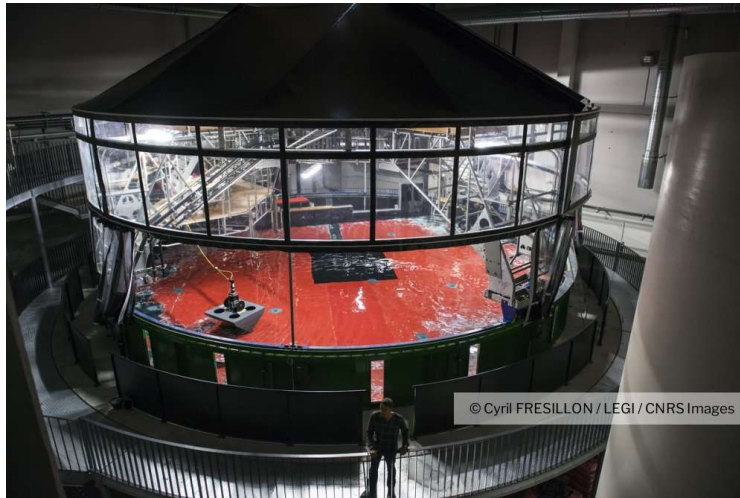
Figure 4.1 : Dispositif exp rimental : plateforme Coriolis (LEGI, Grenoble)
