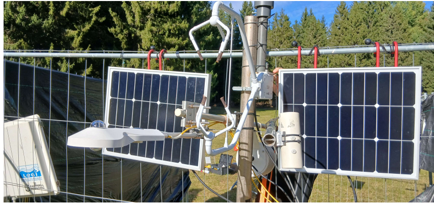
FIGURE 7 – Montage de l'expérience. Ici, nous voyons l'anémomètre sonique et l'alimentation par panneaux solaires, les thermocouples ayant été fixés plus bas
